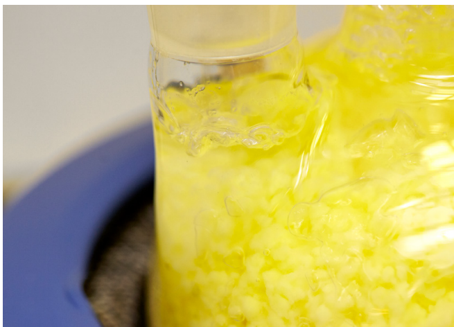
”Vi river cellulosa-fiberna till microfibriller, som slammas upp i vatten och bildar en gel.” Foto: Johan Olsson, RISE
